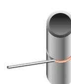
**H-L045** TUBE FIXE. L'AXE DU TUBE EST À 45°.
