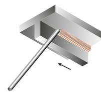
PD SOUDURE D'ANGLE AU PLAFOND
