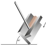
PA SOUDURE EN GOUTTIÈRE
